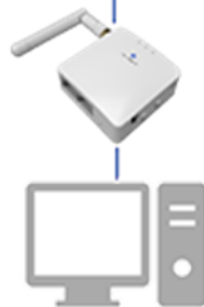
MiniルーターとPCをLANケーブルで接続
